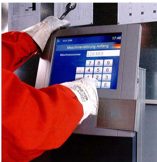
Bild 3: Die Terminals vom Typ B-Net 95 80 sind durch ihre Schutzklasse IP 65 auch für raue Produktionsumgebungen geeignet und lassen sich mit Arbeitshandschuhen bedienen.
